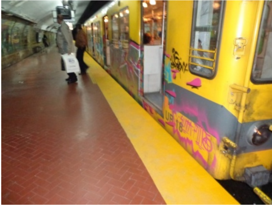
Diferencia de nivel de piso entre coche GEE y andén. E. Ríos – Línea E
