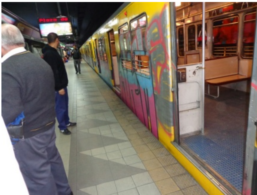
Desnivel entre formaciones y andenes. Bolivar – Línea E
